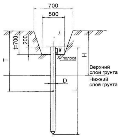
Рис. 2. Установка одиночного заземлителя в двухслойном грунте:
